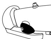
Рис. 30: Замок рамы складного велосипеда в закрытом положении, предохранитель заблокирован
